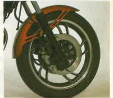
Transmisión por cardán Freno delantero de doble disco
