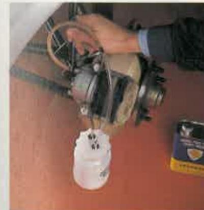
**11** Introduzca el tubo de goma del purgador en la boquilla que hay en la pinza de freno. Con la llave, gire la tuerca un cuarto de vuelta. Pise el pedal del freno hasta que por el tubo sólo salga líquido sin aire.
