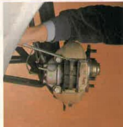
**4** Antes de quitar el pasador metálico que sujeta las pastillas, fíjese bien en qué posición va colocado. A continuación, y con la ayuda del destornillador, saque dicho pasador. Si es necesario ayude con un martillo.
