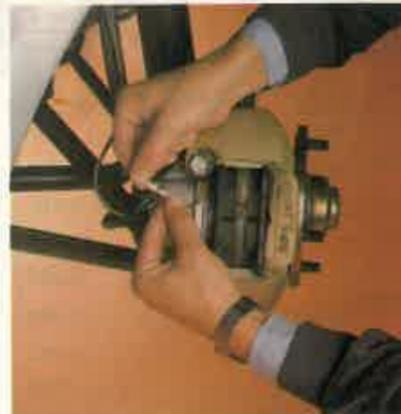
**5** En los coches que tienen avisador del desgaste de las pastillas tiene que desconectar un cablecito eléctrico que llega hasta una de las pastillas. Después, recuerde volverlo a montar.
