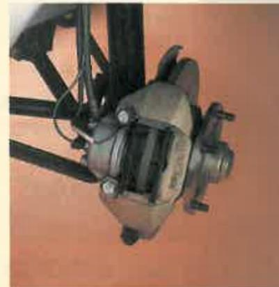
**9** Monte el pasador de alambre nuevo, vuelva a conectar el cable del avisador del desgaste de las pastillas y compruebe que todo el conjunto ha quedado correctamente montado.
