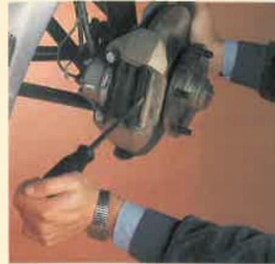
**6** Con la ayuda de un destornillador grande, comprima el émbolo que empuja las pastillas contra el disco. Utilice el destornillador de forma que éste no raye la superficie de fricción del disco.
